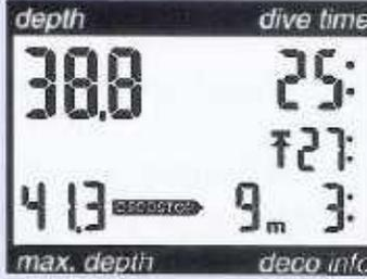
**CEILING** : palier à 3 m avec une durée totale de remontée [ **ASC TIME** ] de 7 min, un autre mode d'affichage.
